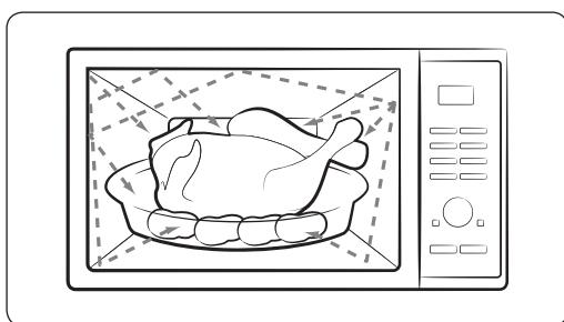
1. De microgolven die door de magnetron worden gegenereerd, worden binnen de ovenruimte heen en weer gekaast en gelijkmatig verspreid terwijl het gerecht op het draaiplateau ronddraait. Hierdoor wordt het gerecht gelijkmatig verwarmd.
