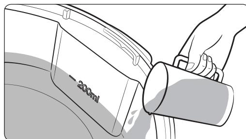
2. Füllen Sie die Tellerwärmeschüssel bis zu der auf der Innenseite des Gefäßes angebrachten Markierungslinie mit Wasser. (Dies entspricht etwa 200 ml.)
