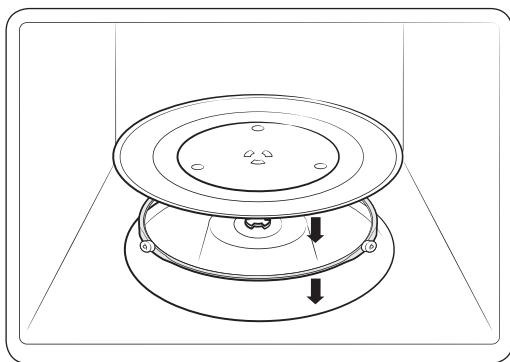
Verwijder het verpakkingsmateriaal uit de oven. Installeer de loopring en het draaiplateau. Controleer of het draaiplateau vrij kan ronddraaien.
