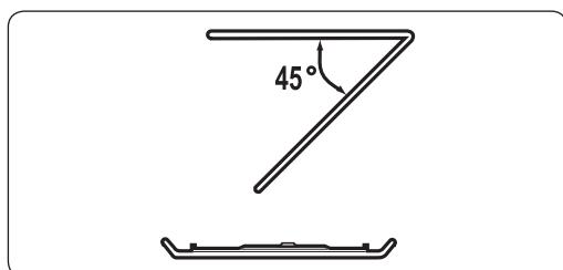
Pour nettoyer la zone supérieure du compartiment de cuisson, abaissez l'élément chauffant supérieur de 45°, comme indiqué. Cela permettra de nettoyer la zone supérieure. Une fois cela fait, repositionnez l'élément chauffant supérieur.
