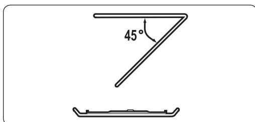
Klappen Sie das Heizelement zum Reinigen der Garraumdecke um 45° nach unten (siehe Abbildung). So können Sie die Decke des Garraums einfacher reinigen. Klappen Sie das Heizelement anschließend wieder nach oben.
