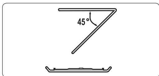
Om de bovenkant van de ovenruimte te reinigen, klap u het bovenste verwarmingselement  $45^{\circ}$  omlaag, zoals wordt weergegeven. Dit helpt om de bovenkant te reinigen. Wanneer u klaar bent, plaatst u het bovenste verwarmingselement terug.
