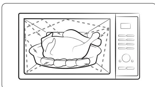
1. Die vom Magnetron erzeugten Mikrowellen werden im Innern des Garraums reflektiert und gleichmäßig verteilt, während sich die Speisen auf dem Drehsteller drehen. So werden die Lebensmittel gleichmäßig erhitzt.
