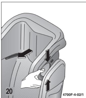
Nakkestøtten, der kan indstilles trinløst, sørger for at barnet sidder sikkert, når det sover, eftersom det sovende barns hoved ikke falder fremover og kommer udenfor nakkestøttens beskyttende område.
