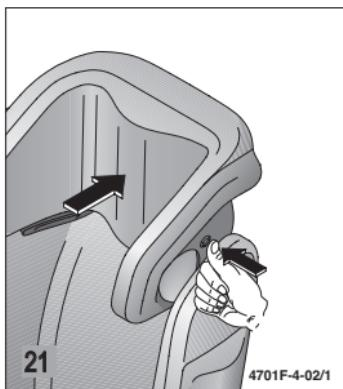
Durch Drücken des Auslassventils kann die Ruheposition für den Kopf stufenlos eingestellt werden.
