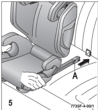
Encochez les connecteurs Seatfix (A) dans l'arceau Isofix, le repère vert des deux connecteurs devant être visible. Vérifiez le verrouillage en tirant des deux côtés sur l'assise.
