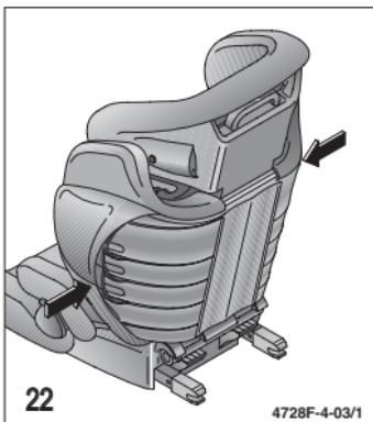
Gli elementi di rinforzo laterali insieme alla fodera migliorano notevolmente la protezione del vostro bambino in caso di collisione laterale e consentono una piacevole ventilazione posteriore in tutto lo schienale.
