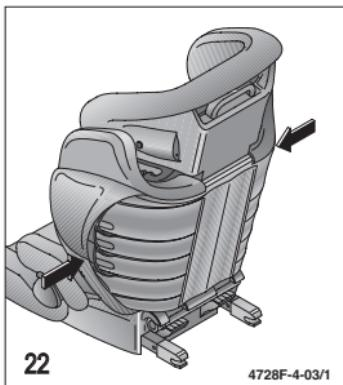
Las nervaduras laterales, en combinación con la funda, mejoran la protección de su hijo en caso de una colisión lateral y posibilitan una ventilación confortable por detrás de todo el respaldo.
