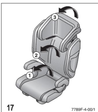
Retire la almohadilla del asiento hacia delante. Proceda de la misma manera para el respaldo y el reposacabezas.
