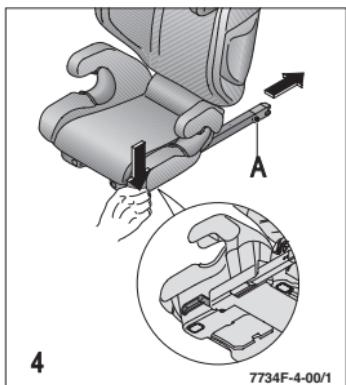
Zum Einbau in Ihr Fahrzeug müssen die Seatfix-Konnektoren (A) ausgefahren werden. Dazu drücken Sie die Rasthebel an den Seiten des Sitzteils und ziehen die Seatfix-Konnektoren nach hinten bis zum Anschlag heraus.
