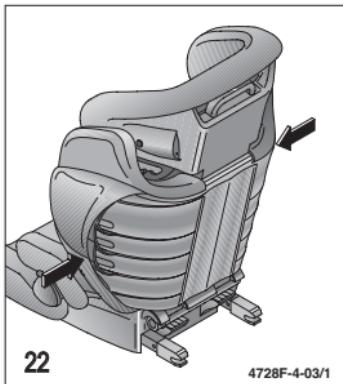
Die seitlichen Verstärkungsrippen verbessern zusammen mit dem Bezug den Schutz Ihres Kindes bei einem Seitenauftprall und ermöglichen eine komfortable Hinterlüftung der gesamten Rückenlehne.
