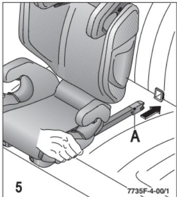
Rasten Sie die Seatfix-Konnektoren (A) in die Isofix- Bügel ein, dabei muss die grüne Markierung an beiden Konnektoren sichtbar werden. Prüfen Sie das sichere Einrasten durch beidseitiges Ziehen an der Sitzfläche.
