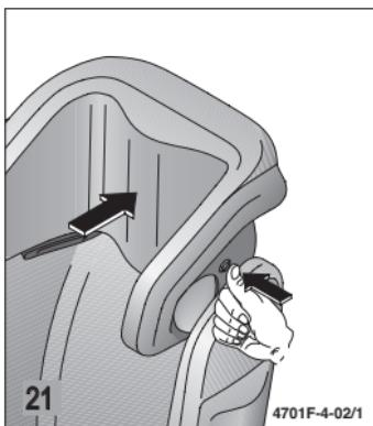
Premendo la valvola di scarico si può regolare in modo continuo la posizione di riposo per la testa.
