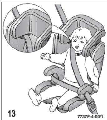
Bältets styrning ska ställas in något ovanför axlarna. Så är barnet fastspänd i barnstolen på rätt sätt.
