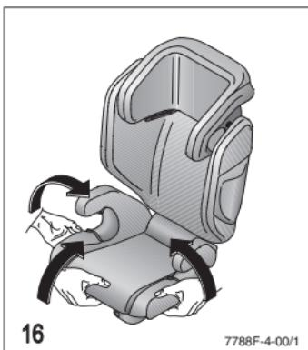
Retire las molduras de plástico inferiores de las respectivas hendiduras. Estire la funda por la parte exterior, comenzando por las guías del cinturón. Estas no deben desmontarse para ello.
