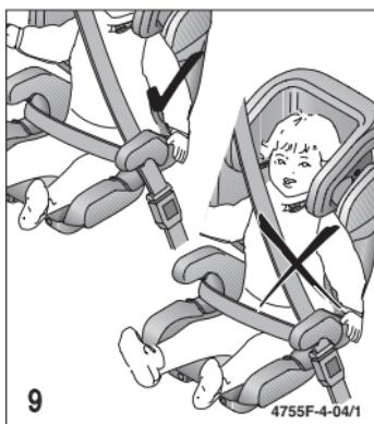
La serrure doit se trouver sous le guidage de la sangle du siège.
