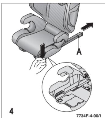
Pred vgradnjo v vozilo je treba izvleci Seatfixova konektorja (A). To naredite tako, da pritisnete zaskočni vzvod na straneh sedežnega dela in Seatfixova konektorja do omejevala izvlečete nazaj.
