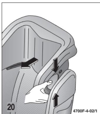
Il poggiatesta regolabile in modo continuo garantisce una posizione sicura per il sonno del bambino, perché la testa del bambino addormentato non cade in avanti e non esce dall'area protettiva del poggiatesta.
