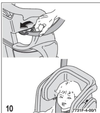
A continuación, coloque el cinturón diagonal en la guía de cinturón del reposacabezas.
