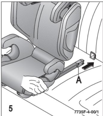
Encage los conectores Seatfix (A) en los estribos Isofix. Durante esta operación tiene que verse la marca verde en ambos conectores. Compruebe el correcto anclaje tirando por ambos lados de la superficie del asiento.
