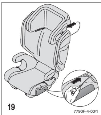
Il cavo di collegamento per il sistema audio è già stato posato sotto l'imbottitura. La tasca per il dispositivo audio si trova sul lato sinistro del cuscino del seggiolino (fig. 19).
