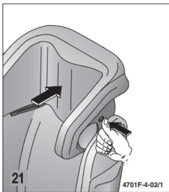
Presionando la válvula de salida puede regular la posición de reposo para la cabeza.
