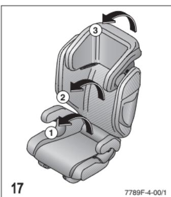
Stáhněte sedací podušku směrem dopředu. Stejným způsobem postupujte v případě zádové a hlavové opěrky.
