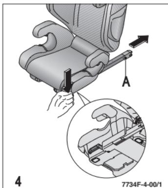
Para el montaje en su vehículo deben extraerse los conectores Seatfix (A). Para ello, presione las palancas de retención situadas en ambos lados del asiento y extraiga los conectores Seatfix hacia atrás hasta el tope.
