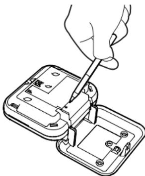
2. Drücken Sie innerhalb dieser fünf Sekunden kurz auf den Testknopf von Melder 1, um die Funkverbindung zwischen den beiden Meldern herzustellen. Melder 1 wird zwei Alarmsequenzen von jeweils drei lauten Pieptönen abgeben.
