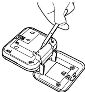
2. Pendant ces cinq secondes, il faut appuyer brièvement sur le bouton de test du détecteur 1 pour relier les deux détecteurs sans fil. Le détecteur 1 émet deux séries de trois bips sonores.
