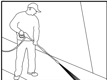
Afbeelding 6: optimale straalhoek tegen een te reinigen oppervlak
