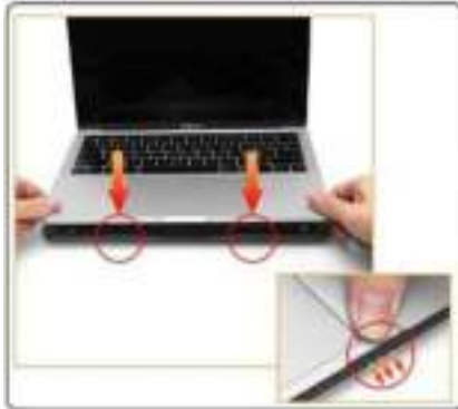
3. Druk de twee voorste klepjes rustig aan om de onderste cover te bevestigen
