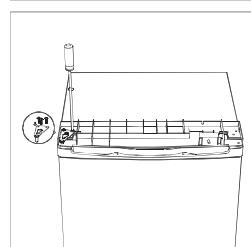
8. Plaats de afdekkap terug op het apparaat en bevestig het met 2 schroeven aan de achterkant.
