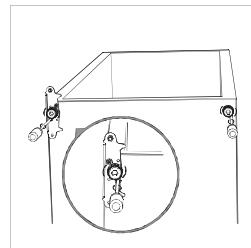
7. Plaats de deur weer op het onderste scharnier. Zorg ervoor dat de deur horizontaal en verticaal is uitgelijnd, zodat de afsluitstrips aan alle kanten goed aansluiten op de deur voordat u het bovenste scharnier definitief bevestigt.
