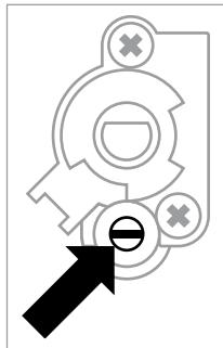
Bei Herden mit einer Schutzvorkehrung wird ein Hahn mit einem Gasaustrittsschutz eingesetzt (siehe die Zeichnung). Die Einstellung der Hähne hat beim betriebenen Brenner in der Sparflammenstellung zu erfolgen, unter Zuhilfenahme eines Regelschraubendrehers der Größe 2,5 mm.
