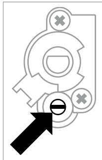
Bij fornuizen met beveiliging is een kraan met een gaslekbeveiliging toegepast volgens de tekening. De kranen moeten ingesteld worden terwijl de brander aan is op de spaarvlam, dit met behulp van een regelschroevendraaier van 2,5 mm.
