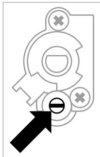
Pour les cuisinières avec protection, un robinet avec une protection contre les fuites de gaz est utilisé, conformément au dessin. Les robinets doivent être réglés tandis que le brûleur se trouve sur la flamme économique, ceci à l'aide d'un tournevis de réglage de 2,5 mm.
