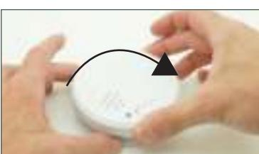
Inserire il rilevatore sulla base e ruotare in senso orario (a destra).
