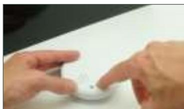
Deze rookmelder is voorzien van een testfunctie. Druk deze in totdat het alarmsignaal klinkt, om een goede werking te verzekeren. Het signaal stopt wanneer u de knop lost. De rookmelder is voorzien van een rode led die, bij normale werking, om de minuut eenmaal brandt.
