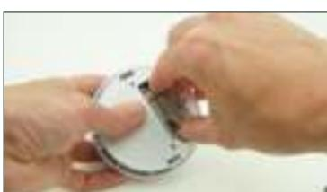
Retirez la pile du compartiment et retirez-en la pellicule en plastique. Connectez la pile au détecteur.
