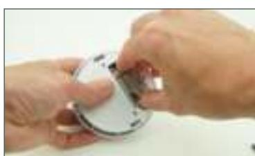
Nehmen Sie die Batterie aus dem Fach heraus und entfernen Sie die Plastikfolie. Schalten Sie die Batterie am Rauchmelder ein.
