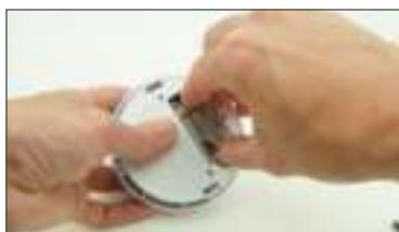
Neem de batterij uit het compartiment en verwijder het plastic omhulsel. Schakel de batterij aan op de melder.
