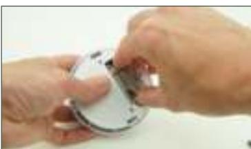
Estrarre la batteria dal vano e rimuovere il coperchio in plastica. Inserire la batteria nel rilevatore.
