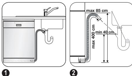
Raccordez le tuyau de vidange au robinet de sortie de l'évier.
