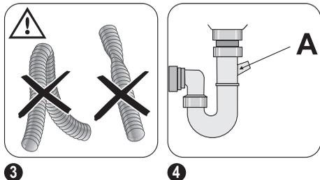
Le diamètre intérieur ne doit pas être inférieur au diamètre du tuyau d'évacuation.
