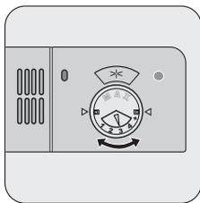
Le liquide de rinçage est réglé d'usine sur le niveau 3.
