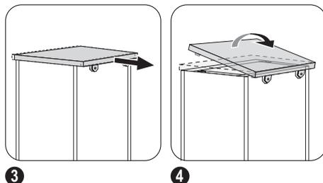
Installeer het werkblad op het apparaat als u de afwas-machine wilt gebruiken als een vrijstaand apparaat. De sokkel van vrijstaande apparaten is niet verstelbaar.
