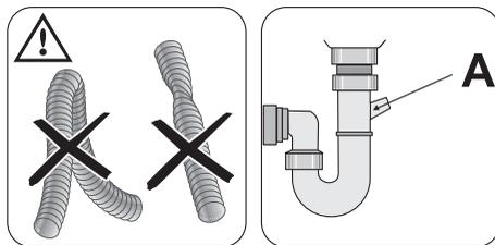
**3** Der Innendurchmesser des Siphons muss mindestens genauso groß sein wie der Durchmesser des Schlauchs. Wenn der Ablaufschlauch an einen Siphon unter einem Spülbecken angeschlossen wird, muss die Kunststoffmembran (A) entfernt werden. Falls Sie die Kunststoffmembran nicht entfernen, kann der Siphon durch Nahrungsreste verstopfen.
