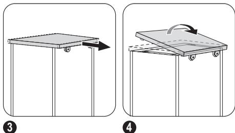
Installieren Sie das Gerät mit seiner oberen Abdeckung, wenn Sie es als freistehendes Gerät verwenden wollen. Der Sockel freistehender Geräte ist nicht einstellbar.
