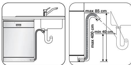
**1** Schließen Sie den Ablaufschlauch an den Siphon an.
