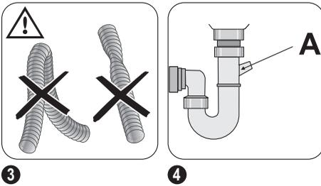
De binnendiameter mag niet kleiner zijn dan de diameter van de slang.
