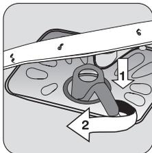
**6** Mettez le système de filtrage en place. Bloquez-les en tournant la poignée dans le sens des aiguilles d'une montre jusqu'à la butée.
