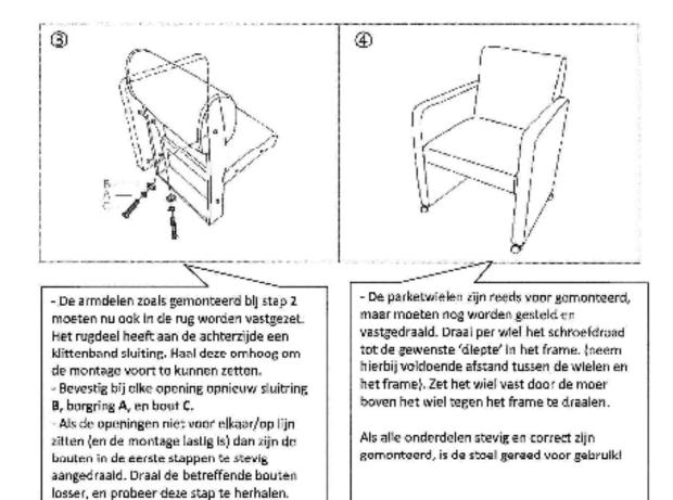
Als alle onderdelen zijn bevestigd, moeten de bouten stevig worden aangedraald.
