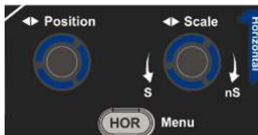
Figure 2-11 Zone de contrôle horizontale
