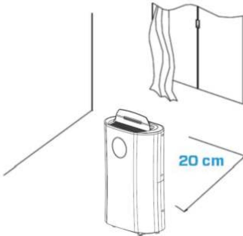
**Avant d'utiliser votre nouveau déshumidificateur et purificateur d'air 2 en 1 Clean Air Optima<sup>®</sup> CA-704 / CA-707.**
