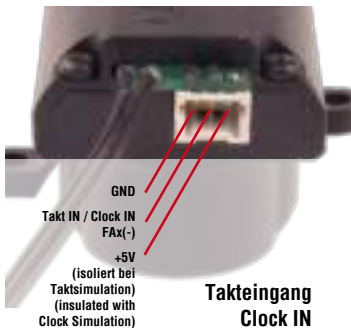
Abbildung 4: Belegung von Takteingang und Taktausgang Illustration #4: Contact Assignment of Clock IN and Clock OUT
