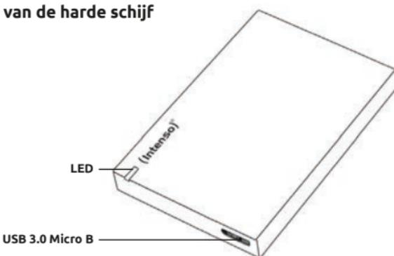
Om de externe harde schijf op uw computer aan te sluiten, uitsluitend de meegeleverde USB-kabel gebruiken. Verbind de USB 3.0 stekker met de Intenso harde schijf en de stekker van het USB-kabeluiteinde met uw computer.
