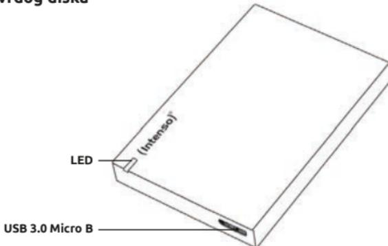
Da biste eksterni tvrdi disk priključili na vaše računalo, upotrijebite isporučeni USB kabel. Spojite USB 3.0 utikač na eksterni tvrdi disk i utikač USB kraja kabela na vaše računalo.
