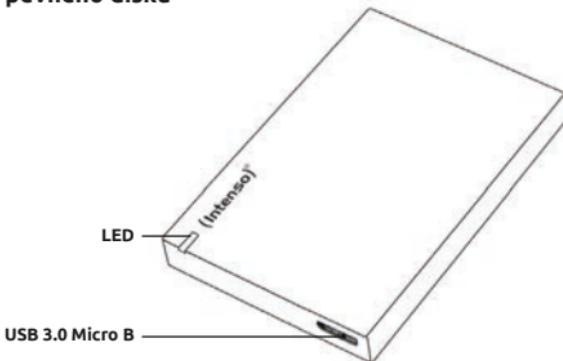
Aby ste pripojili pevný disk k vášmu počítaču, použite iba dodávaný USB kábel. Spojte zástrčku USB 3.0 s pevným diskom Intenso a zástrčku konca kábla USB s vašim počítačom.
