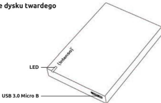
Aby podłączyć zewnętrzny dysk twardego do komputera, należy użyć dostarczonego przewodu USB. Połączyć wtyczkę USB 3.0 z dyskiem Intenso, a tyczkę przewodu USB z komputerem.
