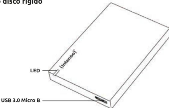
Para ligar o disco rígido externo ao seu computador, utilize apenas o cabo USB fornecido. Ligue a ficha USB 3.0 ao disco rígido Intenso e a ficha da extremidade do cabo USB ao seu computador. O computador deteta o "Novo Hardware" e instala o controlador automaticamente. Aguarde até a instalação do controlador estar concluída. Em "Computador" encontra-se agora disponível uma outra unidade com a designação "Intenso".
