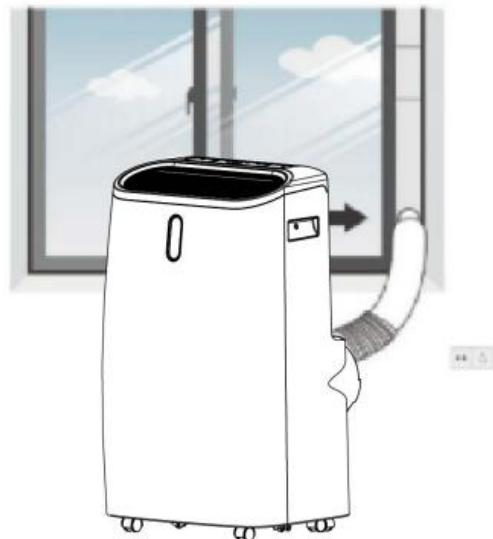
7. Stellen Sie die Lüftungsschlitz am Luftauslass ein und schließen Sie das Gerät an die Steckdose an.
