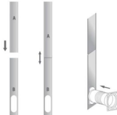
4. Sluit het venster om de kit vast te zetten. Het venster moet de ruitenvit stevig op zijn plaats houden. Zet de ruitenvit indien nodig vast met duct tape. Het is aanbevolen om de opening tussen de adapter en de zijkanten van het raam af te dichten voor een maximale efficiëntie.
