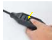
2. Druk op de "RESET"-knop en het indicatorlampje licht rood op.
