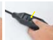
4. Druk op de "RESET"-knop en het indicatorlampje licht rood op. De RCD werkt correct.
