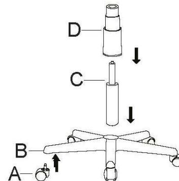
Entfernen Sie vor dem Einbau die Schutzkappe vom Auslösepin der Gasfeder (falls vorhanden). Diese lässt sich leicht entfernen.
