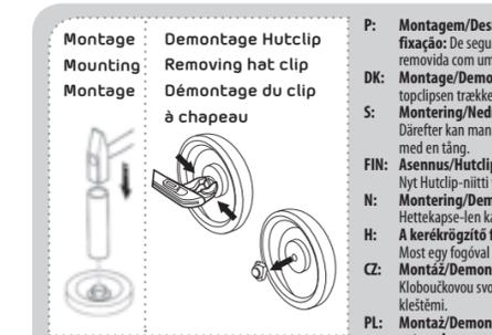
D: Montage/Demontage Hutclip: Der Hutclip läßt sich mit einer Zange abziehen.
