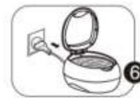
Nach Beendigung des Reinigungsvorgangs ziehen Sie den Stecker aus der Steckdose und öffnen Sie den Deckel. Nehmen Sie den gereinigten Gegenstand aus dem Gerät. Gießen Sie das Wasser aus dem Behälter und wischen Sie diesen anschließend aus.
