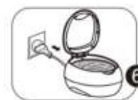
Na beëindiging van het reinigingsproces trekt u de stekker uit het stopcontact en opent u het deksel. Neem het gereinigde voorwerp uit het apparaat. Giet het water uit het reservoir en maak het vervolgens schoon.
