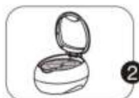
Legen Sie den zu reinigenden Gegenstand ins Wasser. Der Gegenstand sollte vollständig im Wasser eingetaucht sein. Der Wasserstand darf jedoch die Füllmarke MAX nicht überschreiten.
