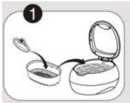
Zur Reinigung eines kleinen Gegenstandes, legen sie diesen in den Plastikkorb. Stellen Sie dann den Korb in den Behälter. Reibungen zwischen dem Gegenstand und dem Behälter können so reduziert werden.
