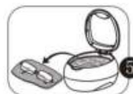
L'appareil met fin automatiquement au processus de nettoyage au bout de 3 minutes. Si un nettoyage supplémentaire devait s'avérer nécessaire, appuyez à nouveau sur le commutateur ON.
