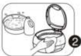
Limpie el depósito utilizando un paño seco y, a continuación seque la carcasa.
