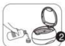
Si el objeto presentara una capa de suciedad especialmente difícil, agregue de 5 a 10 ml. de limpiador (disponible en tiendas de óptica) o unas gotas de limpiador en agua para intensificar el proceso de limpieza.
