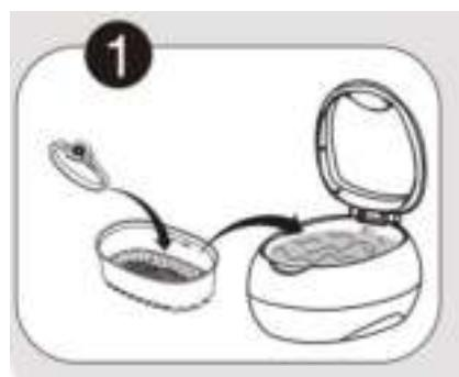
Om een klein voorwerp te reinigen, legt u het in dit plastic mandje. Plaats vervolgens het mandje in het reservoir. Wrijvingen tussen het voorwerp en het reservoir kunnen zo gereduceerd worden.
