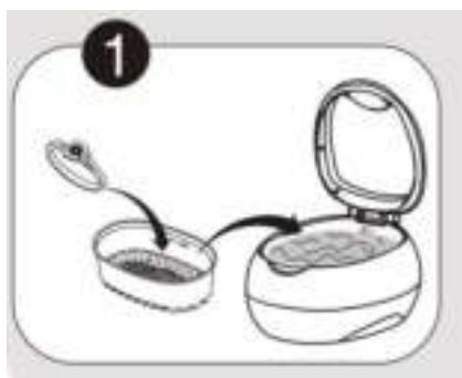
Pour nettoyer un petit objet, mettez-le dans cette corbeille en plastique. Placez ensuite la corbeille dans le réservoir. Ceci permet de réduire les frottements entre l'objet et le réservoir. Cette corbeille en plastique est uniquement destinée au nettoyage de petits objets. La corbeille absorbe environ 30 % des ondes ultrasons ce qui réduit donc le résultat du processus de nettoyage. Lors de l'utilisation du bac plastique, procédez comme décrit au paragraphe « nettoyage renforcé ».
