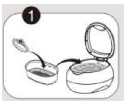
Para limpiar un objeto pequeño, depositelo en la cesta de plástico. A continuación, coloque la cesta en el depósito. Las fricciones entre el objeto y el depósito pueden reducirse de este modo.
