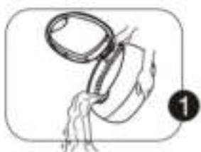
Después del uso, desconecte el enchufe de la toma de alimentación y vacíe el aparato.
