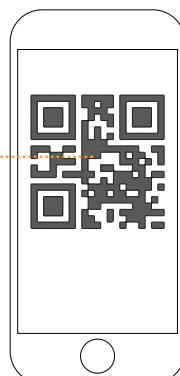
Scannez le code QR affiché sur l'application Ebo avec la caméra du robot et attendez que l'icône et s'éteigne, le robot est alors connecté avec succès.
