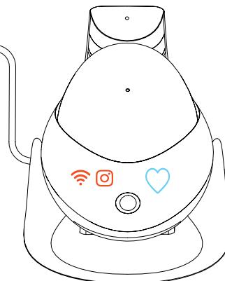
将机器人放在充电桩上充电，当机器人指示灯全亮表示等待联网，
