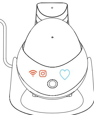
充電スタンドにロボットを置いて充電し、ロボットのランプが完全に点灯すると、図のようにネットワークの待機状態になります。
