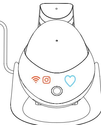
Placez le robot sur le chargeur, quand le voyant du robot est complètement allumé il se signifie que l'attente de la connection du réseau, comme indiqué sur la figure.
