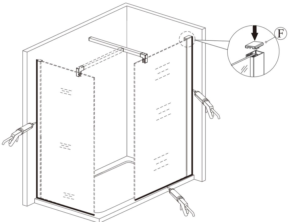
Bitte tragen Sie Sanitärsilikon von außen zwischen Wand und Wandprofil und Duschtasse und dem Profil auf der Duschtasse auf. Nach dem Auftragen muss das Silikon 24 Stunden trocknen, bevor Sie Ihr Produkt das erste Mal nutzen können.
