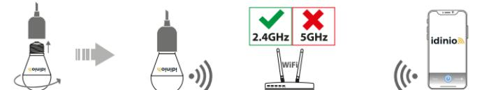
**NL** Steek de slimme lamp in defitting. De lamp zal snel gaan knipperen. Indien dit niet het geval is dan moet u de slimme lamp resetten door hem aan/uit/aan/uit/aan/uit te schakelen.
