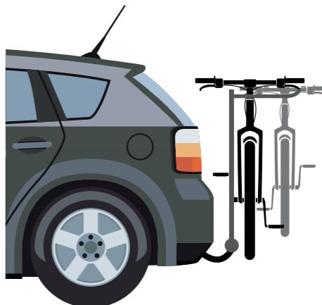
Als de auto is voorzien van een automatische opening van de achterklep, moet deze worden uitgeschakeld of uitsluitend handmatig worden geopend als de fietshouder is gemonteerd.
