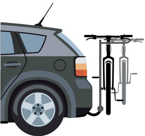
Si le véhicule est équipé d'un hayon automatique, celui-ci doit être déconnecté ou ouvert manuellement seulement si le porte-vélo est fixé.
