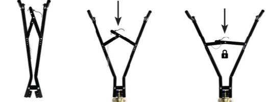
Drücken Sie auf die Feder, um den Träger zu lösen.
