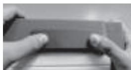
25. Neem de pakkingen van de deur van de koelkast en vrieskast, draai ze 180° en breng ze weer aan.
