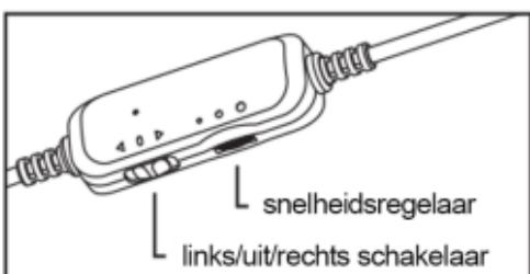
**Stap 4.** Gebruik de links/uit/rechts schakelaar op de USB-kabel om de machine aan of uit te zetten. Gebruik de snelheidsregelaar om de snelheid aan te passen.
