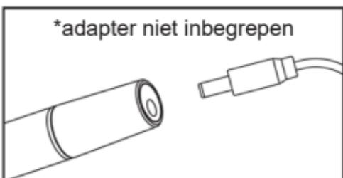
**Stap 3.** Verbind de DC-stekker van de USB-kabel met de nagelfrees en het andere uiteinde met een USB-(telefoon) adapter of powerbank (DC 5V/2A).
