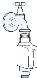
Wateraanvoer aansluiting met aquastop
