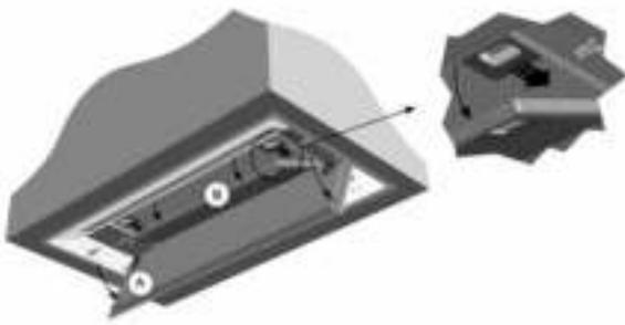
De onderplaat (A) kunt u verwijderen door deze met een zachte neerwaartse beweging open te trekken. Het metalen vetfilter (B) kunt u nu verwijderen door tegelijkertijd het linkse en rechtse slotje in te drukken.
