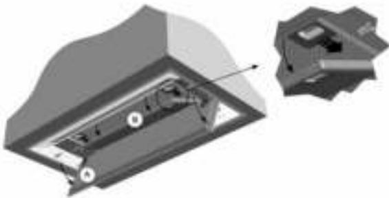
De onderplaat (A) met een zachte neerwaartse beweging open te trekken. De metalen vetfilter (B) kunt u nu verwijderen door tegelijkertijd de linkse en rechtse filtervergrendelingen in te drukken.
