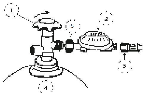
Установите регулятор давления на газовом баллоне, пользуясь большим медным болтом. Болт должен иметь резиновую прокладку. (Примечание: резиновая прокладка не требуется для регуляторов давления в Великобритании.) Сильно затяните болт. Обратите внимание, что мы пользуемся левовинтовым болтом. Проверьте плотность соединения, используя мыльный раствор.
