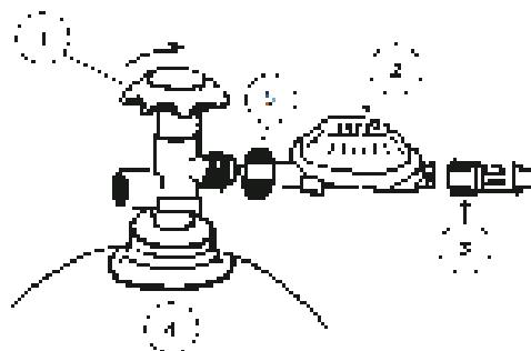
Regulator ciśnienia zamocować na butli gazowej przy pomocy dużej mosiężnej nakrętki. W nakrętce powinna znajdować się gumowa uszczelka. (Uwaga: Gumowa uszczelka nie jest wymagana do regulatorów ciśnienia stosowanych w UK.) Nakrętkę należy mocno dokręcić. Prosimy pamiętać, że mamy tutaj do czynienia z gwintem lewoskrętnym. Sprawdzić, czy połączenie jest szczelne, używając do tego tugu mydanego.
