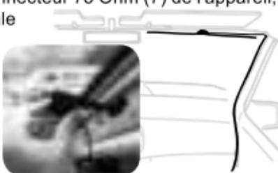
*Ne pas fixer l'antenne DAB au-dessus de fils de chauffage, dans un emplacement susceptible de gêner la visibilité du conducteur, ou dans un endroit sujet aux interférences avec du métal. Pour votre sécurité, ne pas acheminer les câbles de manière à ce que ceux-ci entravent le fonctionnement du véhicule, ou par un emplacement qui risque d'entraver le fonctionnement des sacs gonflables.*
