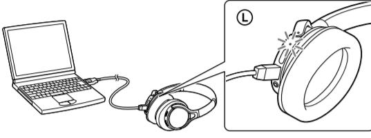
Una vez que la unidad y el ordenador están conectados, se inicia la carga y se ilumina el indicador (rojo). La carga tarda un máximo de 2,5 horas en completarse y el indicador (rojo) se apaga automáticamente.
