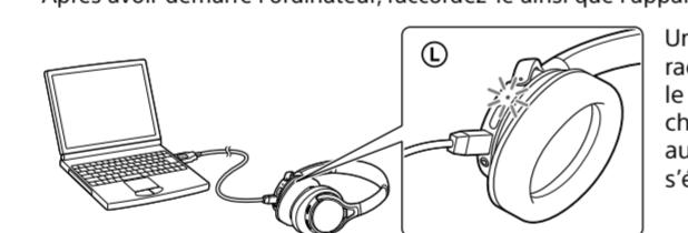
Une fois l'appareil et l'ordinateur raccordés, le chargement démarre et le témoin (rouge) s'allume. Le chargement dure environ 2,5 heures au maximum et le témoin (rouge) s'éteint automatiquement.
