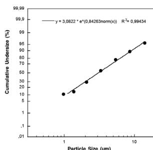
Измерения производились с использованием раствора фторида натрия при помощи импактора нового поколения Next Generation Impactor (NGI). Диаграмма, возможно неприменима для суспензий или очень густых лекарственных препаратов. Подробную информацию можно получить
