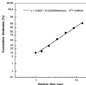
Las mediciones se realizaron con una solución de fluoruro sódico con un "Next Generation Impactor" (NGI). Así pues, el diagrama puede no ser aplicable a suspensiones o medicamentos altamente viscosos. Puede obtener más información del fabricante de la medición.
