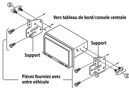
Pour installer cet appareil sur les supports préinstallés dans votre véhicule, installez les vis de montage ② dans les trous de vis appropriés à votre véhicule :
