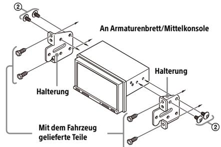
Wenn Sie dieses Gerät an den eingebauten Halterungen des Fahrzeugs montieren, befestigen Sie es mit den Befestigungsschrauben ② in den für den jeweiligen Fahrzeugtyp geeigneten Schraubenbohrungen:
