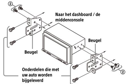
Wanneer u dit toestel monteert op de vooraf geïnstalleerde beugels van uw auto, gebruikt u de montageschroeven ② en steekt u deze in de juiste schroefgaten afhankelijk van uw auto: T voor TOYOTA en N voor NISSAN.
