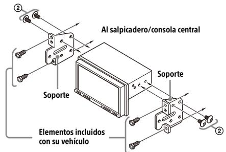
Al montar esta unidad en los soportes preinstalados de su vehículo, utilice los tornillos de montaje ② en los orificios de tornillo adecuados en función de su vehículo:
