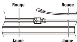
Après avoir fait correspondre correctement les raccordements et les câbles d'alimentation commutée, raccordez l'appareil à l'alimentation du véhicule. Si vous avez des questions et si vous rencontrez des problèmes pour le raccordement de cet appareil qui ne sont pas abordés dans ce mode d'emploi, contactez votre concessionnaire automobile.
