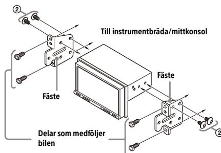
När denna enhet monteras i bilens förinstallerade fästen använder du monteringskruvarna ② i lämpliga skruvhål beroende på vilken bil du har: T för TOYOTA och N för NISSAN.
