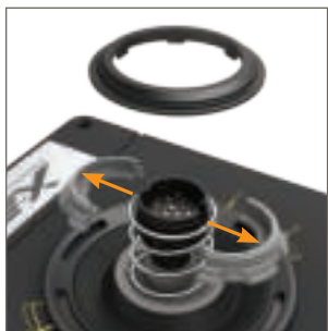
4. Smontare le fascette di bloccaggio
