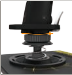
1. Gire el bisel de cierre en sentido contrario al de las agujas del reloj
