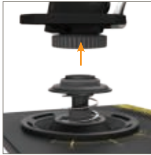
2. Retire la palanca
