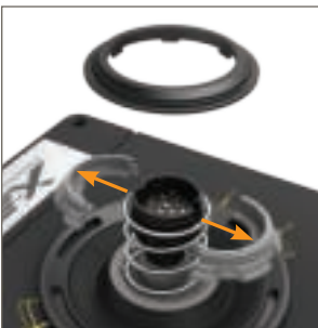
4. Desmonte os Grampos de Bloqueio
