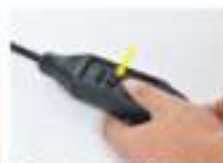
Stlačte tlačidlo „RESET“, kontrolka sa rozsvieti načerveno. Prúdový chránič (RCD) funguje správne
