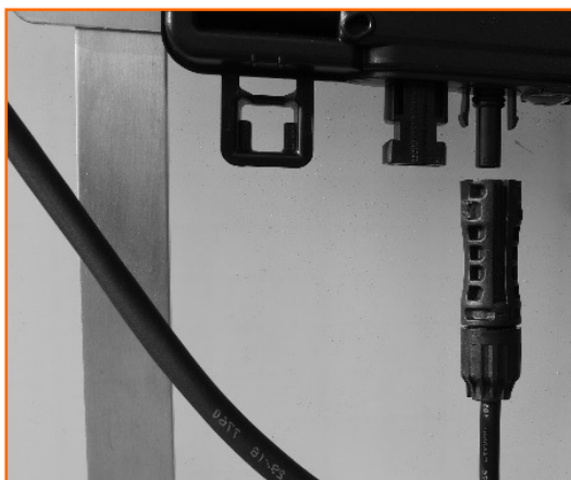
Zonnepaneel stekker vrouwtje aansluiten op micro omvormer
