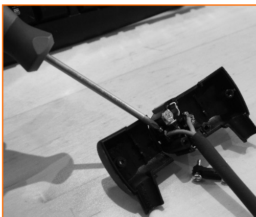
Kabel vastzetten aan pool
