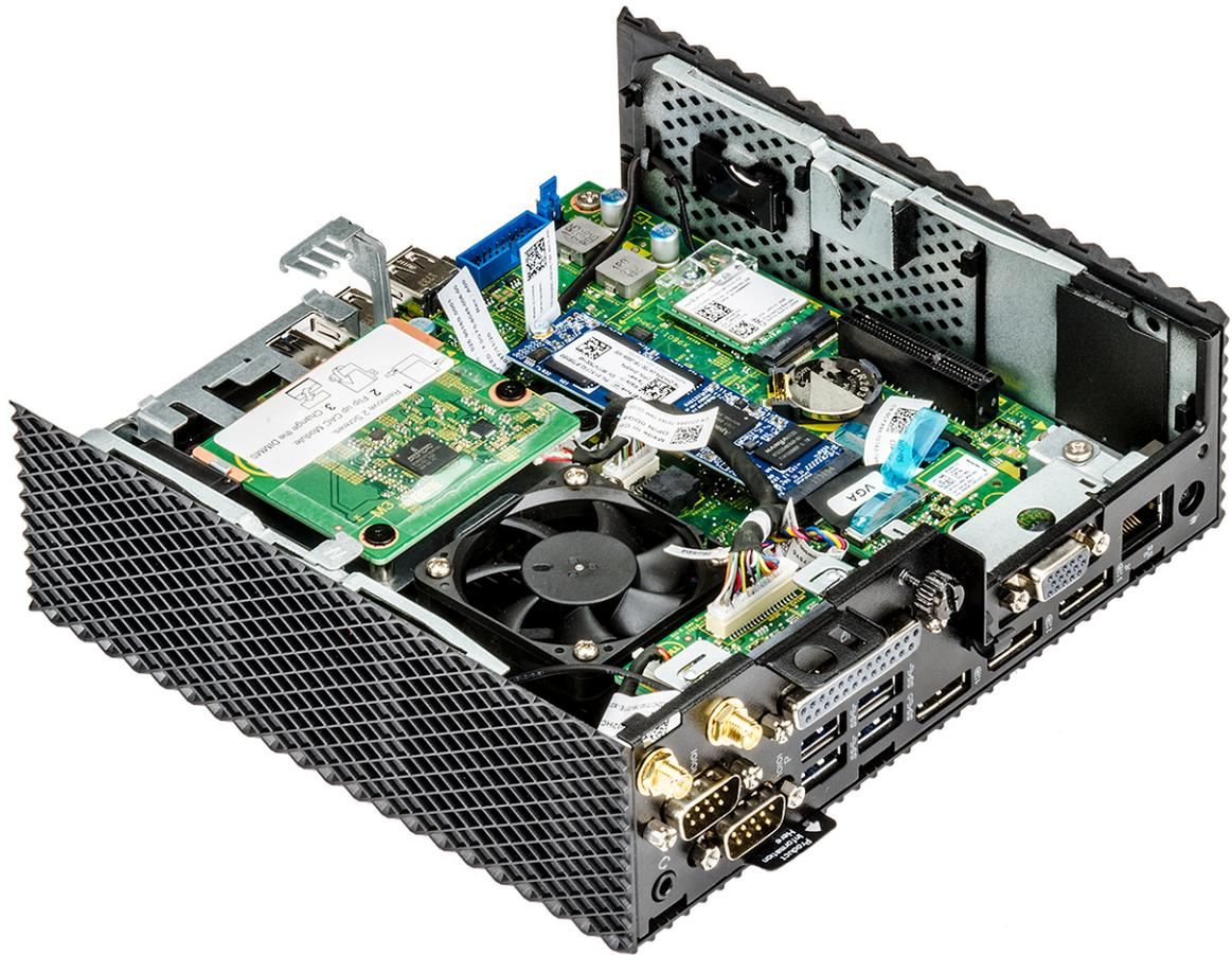
Abbildung 14. PCIe-Modul wird entfernt
