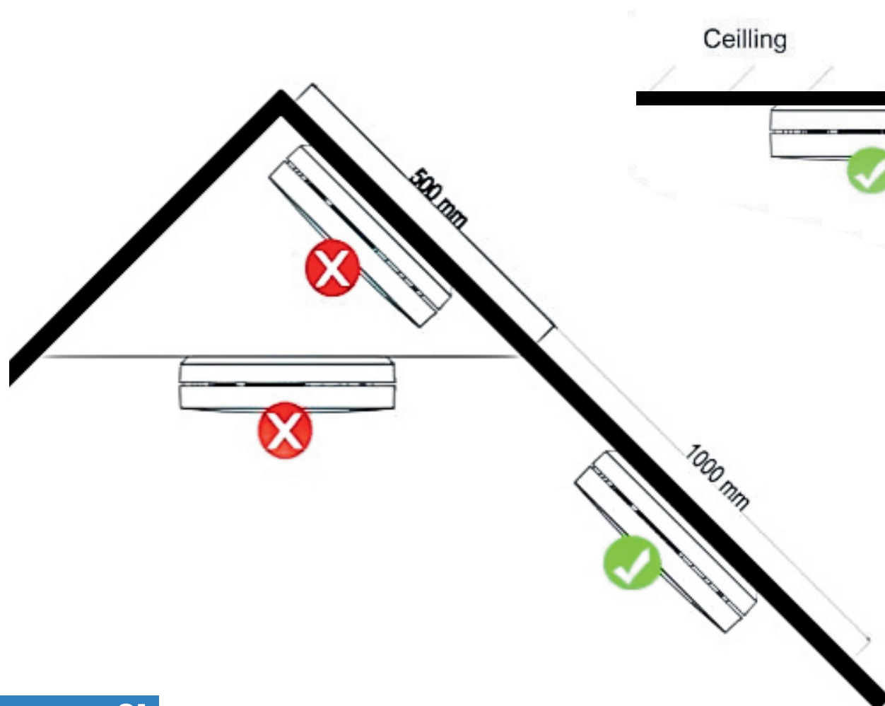
Figura 4: Ubicaciones de montaje recomendadas
