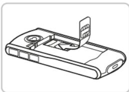
1. Entfernen Sie den Akku-Deckel (Ausnehmung links oben).
