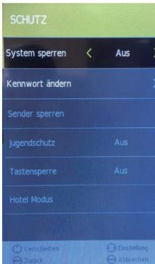
Um in das Sperren-Menü zu gelangen, muss ein Passwort eingegeben werden. Das Standard-Passwort ist 0000. In diesem Menü können Sie das Passwort nach Bedarf ändern.
