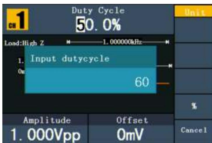
Fig. 0-8 : Réglage du rapport cyclique d'un signal rectangulaire
