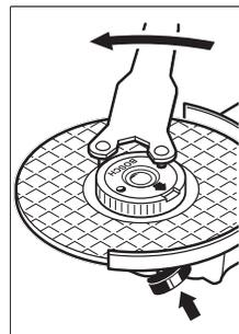
En korrekt fastgjort og in-takt lynspændemøtrik kan løsnes ved at dreje roulettringen mod uret med hånden. **Brug aldrig en tang til at løse en fastsiddende lynspændemøtrik, men anvend i stedet spændenøglen.** Sæt spændenøglen på som vist på billedet.
