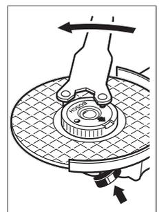
Oikein kiinnitetty ja ehjä pikakiinnitysmutteri on mahdollista avata käsin. Avaa mutteri kiertämällä pyälletty rengasta vastapäivään. **Älä missään tapauksessa avaa kiinni juuttunutta pikakiinnitysmutteria pihdeillä, vaan käytä laikka-avainta.** Aseta laikka-avain kiinnityskohtaan kuvan mukaisesti.
