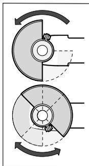
Zet de beschermkap (**7**) op de ashals. Pas de positie van de beschermkap (**7**) aan de eisen van de bewerking aan. Vergrendel de beschermkap (**7**) door de vastzetschroef (**6**) met de binnenzeskant-sleutel (**3**) vast te draaien.
