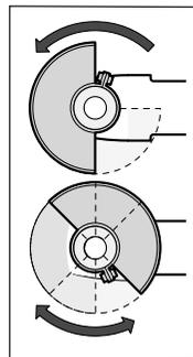
Sæt beskyttelsesskærmen (7) på spindelhalsen. Tilpas beskyttelseskappens (7) position til arbejdsgangens krav. Fastlås beskyttelseskappen (7) ved at spænde indstillingskruen (6) med unbrakonøglen (3).
