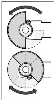
Nałożyć pokrywę ochronną (7) na sztykę wrzeciona. Pozycja pokrywy ochronnej (7) powinna być dopasowana do rodzaju obróbki. Zablokować pokrywę ochronną (7), dokręcając śrubę ustalającą (6) za pomocą klucza sześciokątnego (3).
