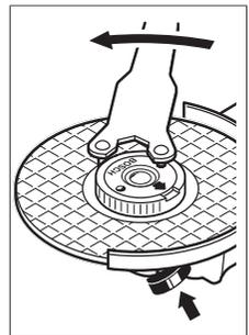
Stiskněte aretační tlačítko vřetena (1), abyste brusné vřeteno zablokovali. Pro utažení rychloupínací matice otáčejte silou brusným kotoučem po směru hodinových ručiček.
