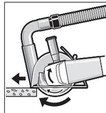
Uključite električni alat i stavite ga na izradak s prednjim dijelom vodilice. Pomičite električni alat umjerenim pomakom prilagođenim materijalu koji obrađujete.
