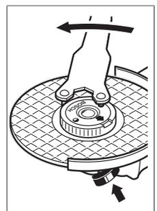
Nõuetekohaselt kinnitatud vigastusteta kiirkinnitusmutri saate vabastada rihveldatud rõngast käega vastupäeva pöörates. **Kõvasti kinnioleva kiirkinnitusmutri vabastamiseks ärge kasutage tange, vaid üksnes kahe tihtviga erivõtit.** Asetage kahe tihtviga võti kohale nii, nagu joonisel näidatud.
