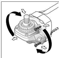
Pode rodar a cabeça do mecanismo de acionamento em passos de 90°. Desta forma, o interruptor de ligar/desligar pode ser colocado na posição de manuseamento mais favorável, p. ex. para esquerdinos, em situações de trabalho especiais.
