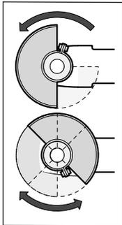
Așază capacul de protecție (7) pe gulerul axului. Adaptează poziția capacului de protecție (7) în funcție de procesul de lucru. Blochează capacul de protecție (7) strângând șurubul de fixare (6) cu ajutorul cheii hexagonale (3).
