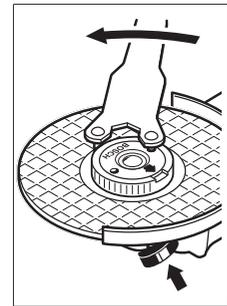
Закріплену належним чином, непошкоджену швидкозатискну гайку можна відпустити, вручну повертаючи кільце з накаткою проти стрілки годинника. Ніколи не відкручуйте швидкозатискну гайку, яка сидить дуже міцно, кліщами – використовуйте ріжковий ключ під два отвори. Приставляйте
