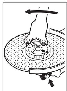
Правилно затегната и изп-равна гайка за бързо затягане можете да развиете чрез завъртане на пръстена обратно на часовниковата стрелка. **В никакъв случай не опитвайте да развивате с клещи блокирана гайка, за целта използвайте ключ с два отвора.** Използвайте ключа с два отвора както е показано на фигурата.
