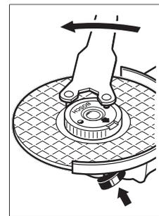
A csiszológengely rögzítéséhez nyomja meg a (1) tengely reteszelő gombot. A gyorsbefogó anya megszorításához forgassa el erőteljesen a csiszolókorongot az óramutató járásával meg egyező irányba.
