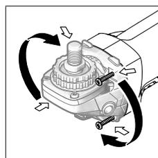
Vaihteiston päätä voi kääntää 90 astetta kerrallaan. Näin käyttökytkimen voi sijoittaa parempaan asentoon erilaisia käyttötilanteita varten, esim. jos koneen käyttäjä on vasenkätinen.
