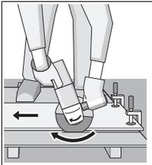
L'outil électroportatif doit toujours travailler en sens opposé. Sinon, il risque de sortir de la ligne de coupe **de façon incontrôlée**. Lors du tronçonnage de profilés et de tubes carrés, il convient de positionner l'appareil sur la plus petite section.
