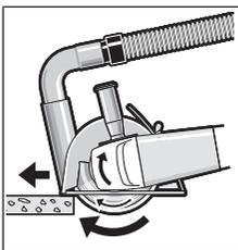
Uključite električni alat i prednjim delom vodećih šina ga stavite na radni komad. Električni alat pomicite ravnomerno, prilagodeno materijalu koji se obrađuje.
