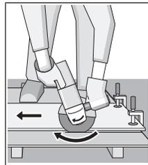
Az elektromos kéziszerszámot mindig a forgásirányával ellentétes irányban kell vezetni. Ellenkező esetben a készülék **irányíthatatlanul** kiugorhat a vágásból. Profilok és négyszögletes csövek darabolásánál a legcélszerűbb a legkisebb keresztmetszetnél kezdeni a darabolást.
