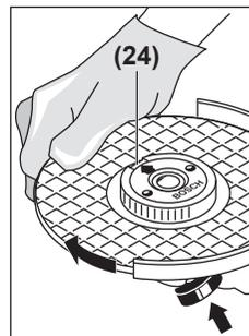
Nacisnąć przycisk blokady wrzeciona (1), aby unieruchomić wrzeciono szlifierki. Aby dokręcić szybkozaciskową nakrętkę mocującą, należy energicznym ruchem obrócić tarczę szlifierską w kierunku zgodnym z ruchem wskazówek zegara.
