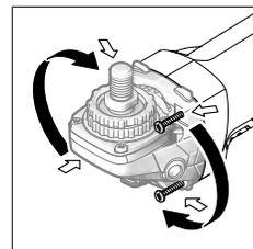
Du kan vrida växelhuvudet i steg om 90°. Då kan på-/avströmbrytaren placeras i en bättre hanteringsposition vid speciella arbetsfall, t.ex. för vänsterhänta personer. Skruva ut de 4 skruvarna helt och hållet. Sväng drevhuvudet försiktigt och utan att ta av det från
