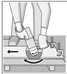
ابزار برقی بایستی همواره در جهت مخالف هدایت شود. در غیر اینصورت ممکن است که دستگاه به صورت غیر قابل کنترل از خط برش بیرون آید. برای برش پروفیل و لوله های چهارگوش، بهتر است برش را از کوچکترین برش مورب شروع کنید.
