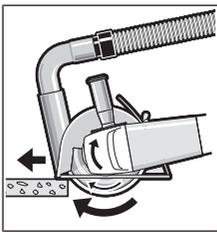
Zapněte elektronářadí a nasadte ho přední částí vodicích saní na obrobek. Posunujte elektronářadí s mírným posuvem přizpůsobeným obráběnému materiálu. Při dělení mimořádně tvrdých materiálů, např. betonu s vysokým podílem
