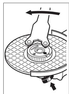
En hurtigspennmutter som er festet riktig og er uskadet, kan løsnes ved at du dreier den riflede ringen for hånd mot urviseren. **En hurtigspennmutter som sitter fast, må aldri løsnes med en tang. Bruk tohullsnøkkelen.** Sett tohullsnøkkelen som vist på bildet.
