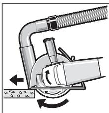
Ieslėdžiet elektroinstrumentu un novietojiet griešanas vadotnes priekšējo malu uz apstrādājamā priekšmeta. Pārvietojiet elektroinstrumentu ar mērenu ātrumu, kas atbilst apstrādājamā materiāla īpašībām.
