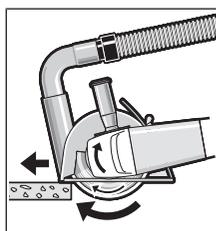
Slå på elektroverktøyet, og sett det på emnet med den fremre delen av styreskinnen. Skyv elektroverktøyet med moderat hastighet, tilpasset materialet som bearbeides.
