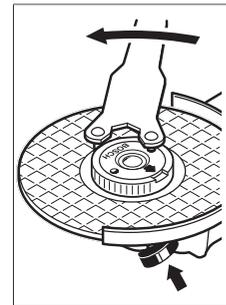
Pritisnite tipku za blokadu vretena (1) kako biste fiksirali brusno vreteno. Za stezanje brzostezne matice okrenite brusnu ploču snažno u smjeru kazaljke na satu.
