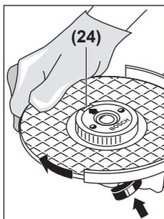
Per bloccare il mandrino portamola, premere il pulsante di bloccaggio dell'alberino (1). Per fissare il dado autoserrante, ruotare con forza la mola abrasiva in senso orario.
