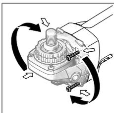
Reduktora galvu var pagriezt 90° iedalījumos. Atsevišķiem darbiem var izvēlēties izdevīgāku ieslēdzēja/izslēdzēja novietojumu, piemēram, ja instrumentu lieto kreillis. Izskrūvējiet 4 skrūves. Uzmaniģi pagriežiet reduktora galvu vēlamajā
