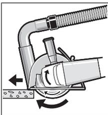
Kytke sähkötyökalu päälle ja aseta se ohjautuen etuosan kanssa työkappaleelle. Työnnä sähkötyökalua eteenpäin rauhallisella, työstettävälle materiaalille sopivalla vauhdilla.
