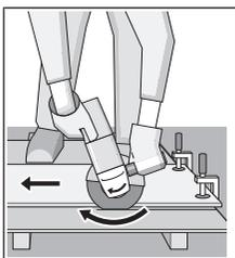
Elektrilise tööriista ettenihke suund peab alati olema vastupidine liikumissuunale. Vastasel korral tekib oht, et tööriist surutakse **kontrollimatult** lõikejoonest välja. Profiilide ja nelikanttorude lõikamist alustage väikseimast ristlõikest.
