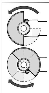
Nasadte ochranný kryt (7) na krk vretena. Nastavte polohu ochranného krytu (7) podľa požiadaviek príslušnej práce. Ochranný kryt (7) zaaretujte utiahnutím zaistovacej skrutky (6) pomocou kľúča s vnútorným šesťhranom (3).
