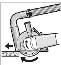
Schakel het elektrische gereedschap in en plaats het met het voorste deel van de geleidebeugel op het werkstuk. Duw het elektrische gereedschap met matige, aan het te bewerken materiaal aangepaste voorwaartse beweging.
