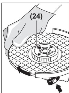
Lihvspindli paigaldamiseks vajutage spindli lukustusnuppu (1). Kiirkinnitusmutri pingutamiseks keerake lihvkettast tugevalt päripäeva.
