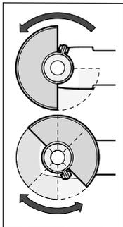
Setzen Sie die Schutzhaube (7) auf den Spindel (16). Passen Sie die Position der Schutzhaube (7) den Erfordernissen des Arbeitsganges an. Arretieren Sie die Schutzhaube (7) durch Festziehen der Feststellschraube (6) mit dem Innensechskantschlüssel (3).
