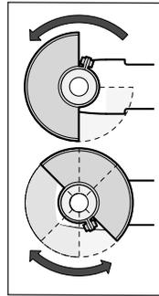
Coloque a tampa de proteção **(7)** na gola do veio. Ajuste a posição da tampa de proteção **(7)** de acordo com os requisitos da operação. Fixe a tampa de proteção **(7)** apertando o parafuso de fixação **(6)** com uma chave sextavada interno **(3)**.
