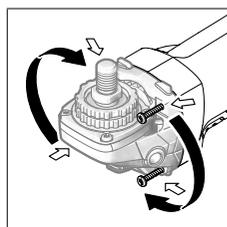
La tête de meuleuse peut être tournée par pas de 90°. Cela permet, lors de certaines applications, d'amener l'interrupteur Marche/Arrêt dans une meilleure position de prise en main, par ex. pour les gauchers. Retirez les 4 vis. Faites pivoter avec précaution la
