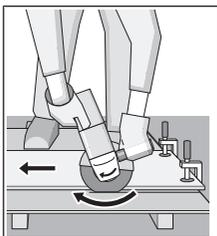
Elverkyet måste alltid föras med motrotation. Annars föreligger risk för att den trycks ut ur kapningen **okontrollerat**. Vid kapning av profiler och fyrkantör är det bäst att sätta an där diametern är som minst.
