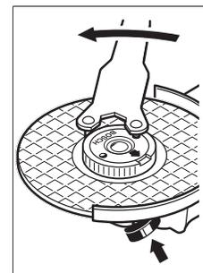
Propisno pričvršćenu, neoštećenu brzosteznu navrtku možete da odvrnete tako što ćete rukom okretati izreckani prsten u smeru suprotnom od kretanja kazaljke na satu. **Nikada nemojte da odvrćete brzosteznu navrtku kleštima, već koristite ključ sa dva otvora.** Postavite ključ sa dva otvora kao što je prikazano na slici.
