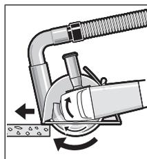
Kapcsolja be az elektromos kéziszerszámot és tegye rá a vezetősín első részével a munkadarabra. Az elektromos kéziszerszámot mérsékelt, a megmunkálásra kerülő anyagnak megfelelő előtolással tolja előre.
