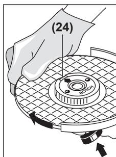
Trykk på spindellåseknappen (1) for å låse slipespindelen. For å låse hurtigspennmutteren dreier du slipeskiven hardt med urviseren.
