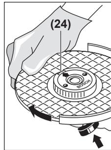
Натисніть на фіксатор шпинделя (1), щоб зафіксувати шліфувальний шпиндель. Для затягнення швидкозатискної гайки із силою поверніть шліфувальний круг за стрілкою годинника.
