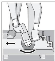
Griešanas laikā elektroinstrumentu vienmēr jāpārvieto atpakaļvirzienā. Pretējā gadījumā pastāv iespēja, ka griešanas disks tiks **nekontrolēti** mestis ārā no griezuma. Griežot profilus un četrstūra caurules, ieteicams uzsākt griešanu vietā ar vismazāko šķērsriezuma laukumu.
