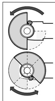
Nasadte ochranný kryt (**7**) na krk vřetena. Nastavte polohu ochranného krytu (**7**) podle požadavků příslušné práce. Zaaretujte ochranný kryt (**7**) utažením zajišťovací šroubu (**6**) klíčem na vnitřní šestihran (**3**).
