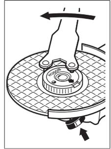
Usulüne uygun olarak takılmış ve hasarsız bir hızlı germe somununu tırtıllı halkayı saat hareket yönünün tersine çevirerek gevşetebilirsiniz. **Sıkışan hızlı germe somununu hiçbir zaman bir pense ile gevşetmeyin, iki pimli anahtar kullanın.** İki pimli anahtar resimde görüldüğü gibi yerleştirin.
