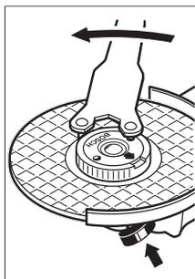
Se integro e correttamente fissato, il dado di serraggio rapido si potrà allentare manualmente, ruotando l'anello zigrinato in senso antiorario. **Se il dado autoserrante è inceppato, non allentarlo in alcun caso utilizzando una pinza, ma utilizzare la chiave a due perni.** Applicare la chiave a due perni come indicato in figura.
