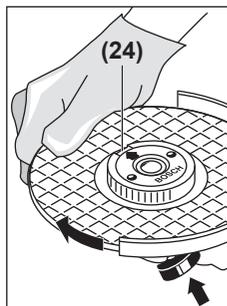
Pritisnite tipko za blokado vretena (1) za blokado brusilnega vretena. Če želite hitrovpenjalno matico zategniti, privijte brusilno ploščo močno v desno.
