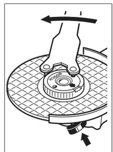
En korrekt fäst och oskadad snabbspänningsmutter kan du lossa genom att vrida den räfflade ringen moturs för hand. **Lossa aldrig en åtdragen snabbspänningsmutter med en tång, utan används kombinyckeln.** Sätt an kombinyckeln på det sätt som visas på bilden.
