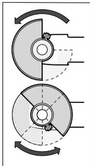
Установите защитный кожух (7) на шейку шпинделя. Отрегулируйте положение защитного кожуха (7) в соответствии с требованиями рабочего процесса. Зафиксируйте защитный кожух (7), затянув крепежный винт (6) с помощью ключа-шестигранника (3).
