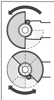
Sätt på skyddskåpan (7) på spindelhalsen. Anpassa skyddskåpan (7) position till arbetsstegets krav. Lås skyddskåpan (7) genom att dra åt låsskruven (6) med insexnyckeln (3).
