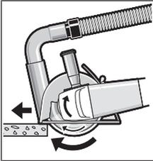
Elektrikli el aletini açın ve kılavuz kızığın ön parçasını iş parçası üzerine yerleştirin. Elektrikli el aletini hafif bir bastırma kuvveti ve işlediğiniz malzemeye uygun bir tempo ile itin. Örneğin yüksek çakıl içerikli beton gibi özellikle sert
