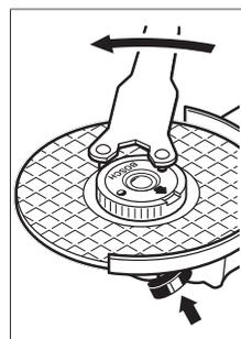
Drücken Sie die Spindel-Arretiertaste (1), um die Schleifspindel festzustellen. Um die Schnellspannmutter festzuziehen, drehen Sie die Schleifscheibe kräftig im Uhrzeigersinn.
