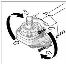
Možete okretati glavu prenosnika u koracima od  $90^\circ$ . Na taj način možete prekidač za uključivanje-isključivanje za posebne slučajeve u radu dovesti u povoljniju poziciju za držanje ruke, na primer za levoruke.
