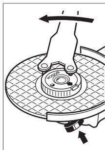
Dacă piulița cu strângere rapidă este nedeteriorată și a fost fixată corespunzător, o puteți slăbi manual, prin rotirea manuală în sens antiorar a inelului zimțat. **Nu slăbiți niciodată cu cleștele o piuliță cu strângere rapidă blocată, ci folosiți cheia pentru șplinturi în acest scop.** Așezați cheia pentru șplinturi conform reprezentării din imagine.
