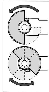
Coloque la cubierta protectora (7) sobre el cuello del husillo. Adapte la posición de la caperuza protectora (7) a las necesidades del paso de trabajo. Bloquee la cubierta protectora (7) apretando el tornillo de sujeción (6) con la llave macho hexagonal (3).
