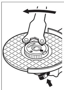
Prawidłowo zamocowaną, nieuszkodzoną szybkozaciskową nakrętkę mocującą można łatwo odkręcić ręką, obracając pierścień radełkowany w kierunku przeciwnym do ruchu wskazówek zegara. **Zbyt mocno dokręconej szybkozaciskowej nakrętki mocującej nie wolno odkręcać za pomocą kombinerek, lecz należy użyć klucza widelkowego.** Przyłożyć klucz
