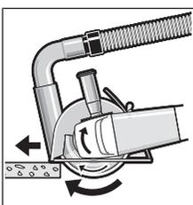
Sätt på elverkyet och sätt det med den främre delen av styrskenan på arbetsstycket. Skjut elverkyet med jämna drag som är anpassade efter materialet.
