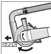
Accendere l'elettrotensile ed applicarlo con la parte anteriore della slitta di guida sul pezzo in lavorazione. Spingere l'elettrotensile verso il materiale da lavorare, con un avanzamento moderato e idoneo al materiale da lavorare.
