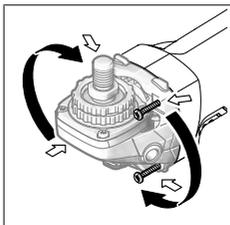
Головку редуктора можна повертати з інтервалом у 90°. Це забезпечує кращий доступ до вимикача при виконанні певних робіт, напр., якщо Ви лівша.
