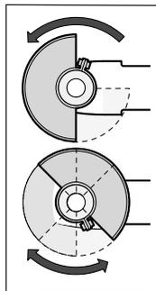
Zaščitni pokrov (7) namestite na steblo vretena. Položaj zaščitnega pokrova (7) prilagodite zahtevam delovnega postopka. Blokirate zaščitni pokrov (7) tako, da zategnete nastavitveni vijak (6) s šestrobim ključem (3).
