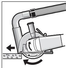
Porniți scula electrică și așezați-o cu partea frontală a saniei de ghidare pe piesa de lucru. Împingeți scula electrică cu avans moderat, adaptat la materialul de prelucrat.
