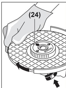
Ажарлау шпинделін (1) бекіту үшін шпиндельді бекіту түймесін басыңыз. Тез қысқыш гайканы бекемдеу үшін ажарлау дискісін күш салып сағат тілінің бағытымен бұраңыз.
