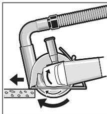
Включете електроинструмента и го поставете върху детайла с предната част на водещата шейна. Придвижвайте електроинструмента с умерено подаване, съобразено с обработвания материал.
