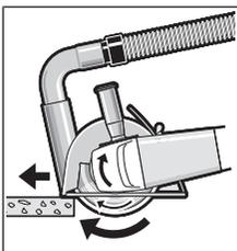
Zapnite elektrické náradie a priložte ho prednou časťou vodiacich sánok na obrobok. Posúvajte elektrické náradie s miernym posúvaním, prispôsobeným opracovávanému materiálu. Pri rezaní mimoriadne tvrdých materiálov, napríklad betónu s veľkým obsa-
