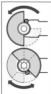
Надіньте захисний кожух (7) на шийку шпинделя. Встановіть захисний кожух (7) в необхідне для виконуваної роботи положення. Зафіксуйте захисний кожух (7), затягнувши фіксуючий гвинт (6) ключем-шестигранником (3).
