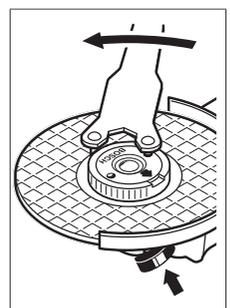
Druk op de asblokkeerknop (1) om de slijpas vast te zetten. Om de snelspanmoer vast te draaien, draait u de slijpschijf krachtig met de klok mee (naar rechts).
