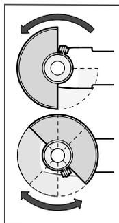
Placez le capot de protection **(7)** sur le collet de broche. Adaptez la position du capot de protection **(7)** aux exigences du travail à effectuer. Bloquez le capot de protection **(7)** en serrant la vis de blocage **(6)** au moyen de la clé mâle pour vis à six pans **(3)**.
