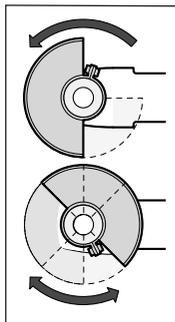
Sett verneaksel (7) på spindelhalsen. Tilpass plasseringen av verneaksel (7) etter arbeidsoperasjonen. Lås verneaksel (7) ved å stramme låseskruen (6) med unbrakonøkkelen (3).
