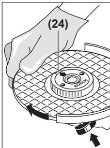
Tryck på spindellåsningen (1) för att arretera slipspindeln. För att dra åt spindelspannmuttern skruvar du slipskivan kraftigt medurs.
