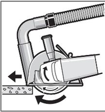
Вклучете го електричниот алат и поставете го со предниот дел на лизгачките водилки на делот што се обработува. Поместувајте го електричниот алат со умерено движење по материјалот што се обработува.
