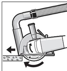
Vključite električno orodje in ga s sprednjim delom vodila namestite na obdelovanec. Srednje močno potiskajte električno orodje in potiskanje prilagajajte obdelovancu. Pri rezanju posebej trdih obdelovancev, npr. betona z visoko vsebnostjo proda, se lahko diamantna rezalna plošča pregreje in tako poškoduje. Jasen znak za to je močno iskrenje, ki spremlja rezanje z diamantno rezalno ploščo.
