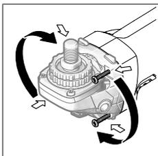
Glavu prijenosnika možete zakrenuti u koracima od 90°. Na taj se način prekidač za uključivanje/isključivanje može prebaciti u povoljniji položaj rukovanja za posebne slučajeve primjene, npr. za ljevake.
