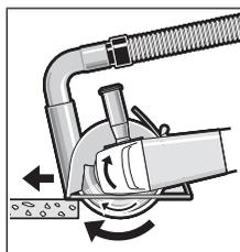
Ενεργοποιήστε το ηλεκτρικό εργαλείο και ακουμπήστε το με το μπροστινό μέρος του πέλαμας οδήγησης πάνω στο επεξεργαζόμενο κομμάτι. Σπρώξτε το ηλεκτρικό εργαλείο με μέτρια προώθηση, προσαρμοσμένη στο επεξεργαζόμενο υλικό.
