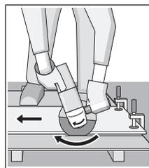
Električni alat morate stalno da vodite u suprotnom smeru. Inače postoji opasnost da se nekontrolisano potisne iz reza. Prilikom razdvajanja profila i četvorougaoe cevi najbolje je da postavite najmanji poprečni presek.
