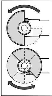
Applicare la cuffia di protezione (7) sul collare dell'alberino. Adattare la posizione della cuffia di protezione (7) in base alla lavorazione da eseguire. Bloccare la cuffia di protezione (7) serrando la vite di fissaggio (6) con la chiave a brugola (3).
