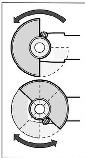
Поставете предпазния кожух (7) върху шийката на вала. Регулирайте позицията на предпазния кожух (7) съобразно конкретните работни условия. Фиксирайте предпазния кожух (7) чрез затягане на финта (6) с комбинирания ключ (3).
