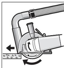
El-værktøjet skal altid føres i modløb. Ellers er der risiko for, at det **ukontrolleret** trykkes ud af snittet. Ved skæring af profiler og firkantrør er det bedst at starte ved det mindste tværsnit.
