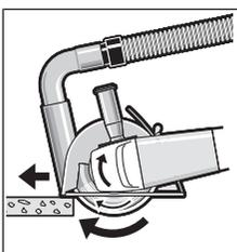
Włączyć elektronarzędzie i oprzeć je przednią częścią przewodniczą saneczkowej o obrabiany przedmiot. Pracować z równomiernym posuwem, dostosowanym do właściwości obrabianego materiału.
