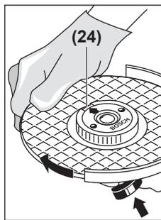
Tryk på spindellåsetasten (1) for at låse slibespindlen. For at spænde lynspændemøtrikken skal du dreje slibeskiven hårdt med uret.
