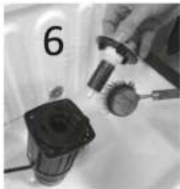
Rotor met water en borstel schoonmaken
