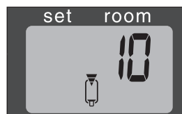
K: Kun FUEL-merkkivalo syttyy, tietonäytössä näytetään, kuinka moneksi minuutiksi säiliössä on polttoainetta.
