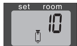
K: När FUEL-indikatorn har dykt upp visar informationsdisplayen hur många minuters brinntid bränslet som är kvar i bränsletanken räcker till.
