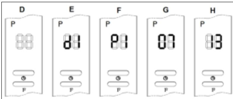
4. Potom stlačte tlačidlo (DAY); na displeji sa zobrazí „d1“. Prejdite na požadovaný deň opäťovným stlačením tlačidla „DAY“; d1 = pondelok, d2 = utorok atď. Ak nastavíte pondelok, na displeji sa zobrazí (blikajúci) obr. E.
