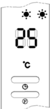
moins de 2°C, il sélectionne la mi-puissance. Si la température réglée est atteinte ou dépassée, l'élément chauffant est désactivé, mais le ventilateur continue encore à tourner pendant 30 minutes. Ainsi, l'appareil garde l'air en mouvement dans la pièce et peut sentir de manière optimale si la pièce refroidit. Après 30 minutes, l'appareil retourne en veille. Dès que la pièce refroidit jusqu'à 2°C sous la température réglée, l'appareil recommence à fonctionner.
