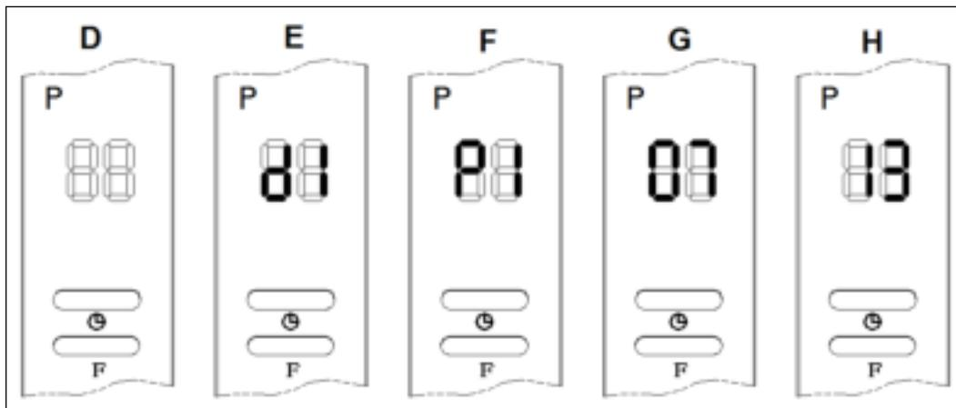
4. Nyní stiskněte ; na displeji se zobrazí „d1“. Opětovným stisknutím „DAY“ přejděte na správný den: d1 = pondělí, d2 = úterý atd. Když nastavíte pondělí, ukáže se na displeji (blikající) obr. E.
