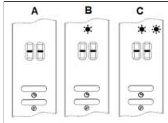
Po dosažení nastaveného času se přístroj automaticky zapne. Teplota je standardně nastavená na 23 °C. Když pracujete s tlačítky přístroje, nelze nastavovat termostat.
