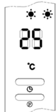
temperatuur bereikt of overschreden dan wordt het verwarmingselement uitgeschakeld maar blijft de ventilator nog 30 minuten draaien. Het apparaat houdt zo de lucht in de ruimte in beweging en is derhalve optimaal in staat te voelen of de ruimte afkoelt. Na 30 minuten keert het apparaat terug naar de standby-stand. Zodra de ruimte afkoelt tot 2°C onder de ingestelde temperatuur hervat het apparaat zijn werking.
