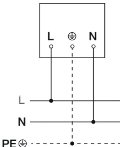
Przewód zasilający jest kablem 3-żyłowym:
