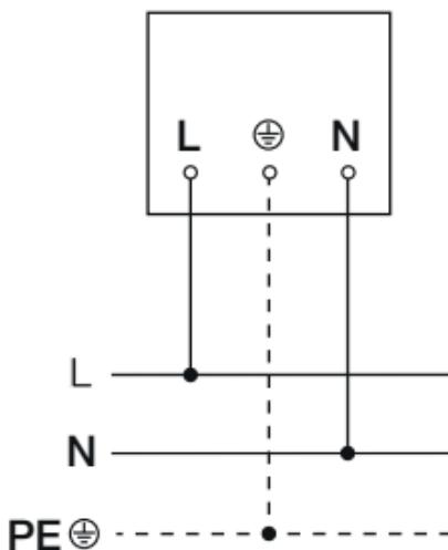
电源供电线由一根三芯电缆构成：
