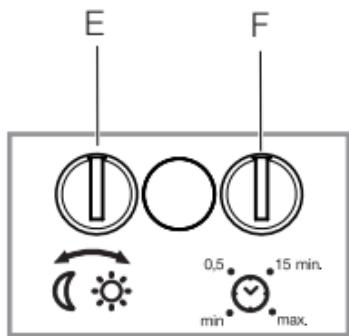
E Установка сумеречного включения
