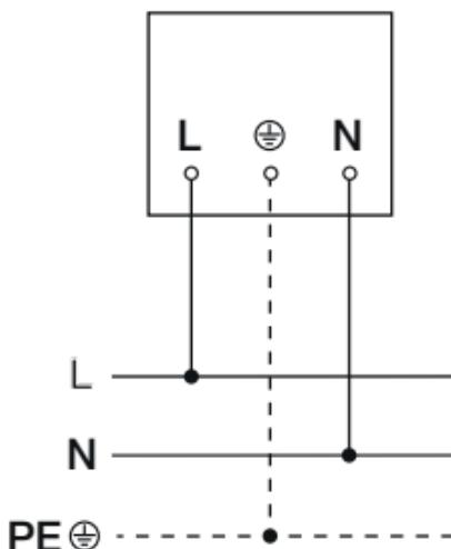
A hálózati betápvezeték 3-erű kábelből áll:
