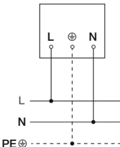
K připojení k elektrické sítí použijte třípolový kabel:
