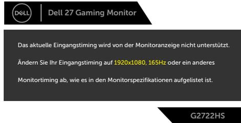
Das bedeutet, dass der Monitor sich nicht mit dem vom Computer empfangenen Signal synchronisieren kann. Die durch diesen Monitor adressierbaren horizontalen und vertikalen Frequenzbereiche können Sie den [Technische Daten des Monitors](#) entnehmen. Der empfohlene Modus beträgt 1920 x 1080.
