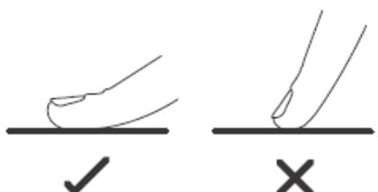
Сенсоры управления прибора легко реагируют на прикосновения, поэтому не следует сильно давить на них. Используйте подушечку пальца, а не его кончик.
