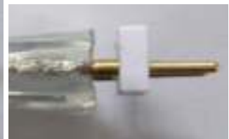
Seitenansicht nach Sicherung des 2-Pin Steckers
