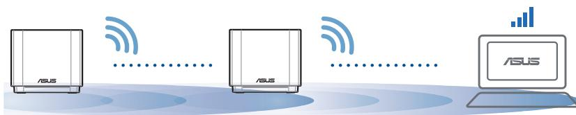
**OPOMBE:** Usmerjevalniki ne smejo biti v bližini naprav, kot so brezžični telefoni, naprave Bluetooth in mikrovalovne pečice, da čim bolj zmanjšate motnje.
