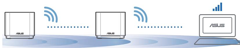
**ملاحظات:** لتقليل التداخل، يُنصح ببعض جهاز التوجيه بعيداً عن الأجهزة كالهواتف اللاسلكية وأجهزة Bluetooth وأفراط الميكروويف. ننصح بوضع أجهزة التوجيه بمكان مفتوح أو واسع.
