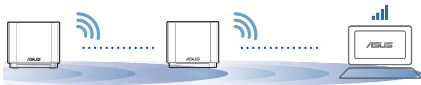
**ПРИМЕЧАНИЯ:** Для уменьшения помех расположите роутеры вдали от беспроводных устройств, например беспроводных телефонов, устройств Bluetooth и микроволновых печей.
