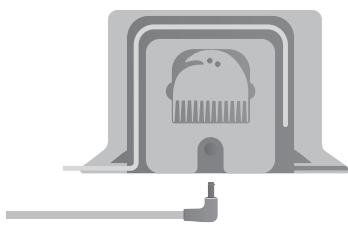
Valitse tyhjä alue, johon Wi-Fi-yhteys yltää hyvin. Varmista, että latausasema on seinää vasten ja kytetty pistorasiaan.
