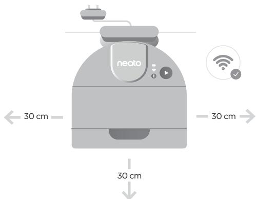
Placer robotten op mod opladningsstationen. Når den er korrekt tilsluttet, lyser batteriikonet.
