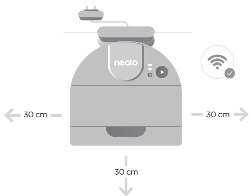
Stellen Sie den Roboter an die Ladestation. Wenn er richtig angedockt ist, leuchtet das Batteriesymbol auf.
