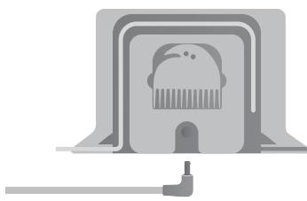
Selecteer een leeg gebied met goede Wi-Fi-dekking. Zorg ervoor dat het laadstation tegen de wand is geplaatst en is aangesloten.
