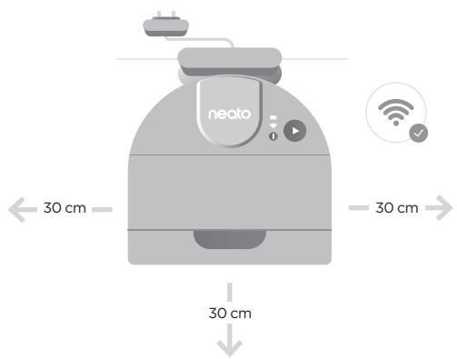
Placera robotten mot laddningsstationen. Batteriikonen tänds när robotten är ansluten korrekt.
